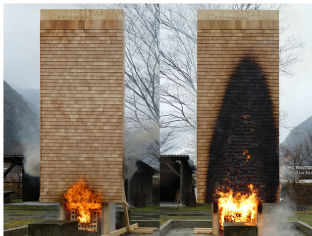
Un essai d'incendie de la façade en bardeaux
